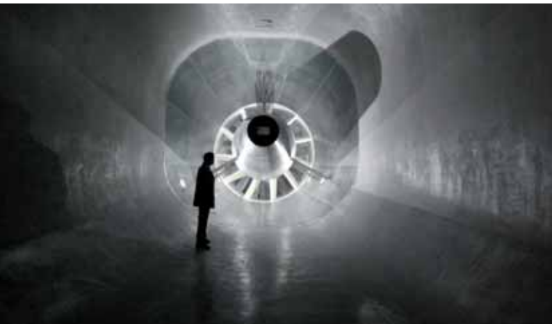
2010 eröffnete das DLR gemeinsam mit der Stiftung Deutsch-Niederländische Windkanäle (DNW) den leistungsfähigsten aeroakustischen Windkanal der Welt. In Windkanälen untersuchen Wissenschaftler die aeroakustischen Eigenschaften von Objekten wie Triebwerken oder Tragflächen. Der Braunschweiger Windkanal kann sowohl für Flugzeuge als auch für Autos eingesetzt werden. Foto: DNW
