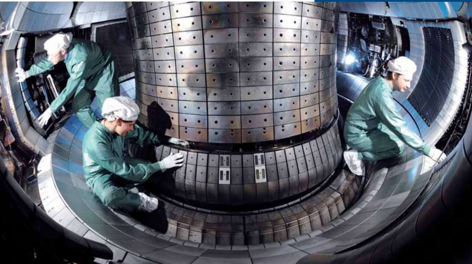
Das Plasmagefäß der Fusionsanlage ASDEX Upgrade. Foto: IPP/V. Rohde
