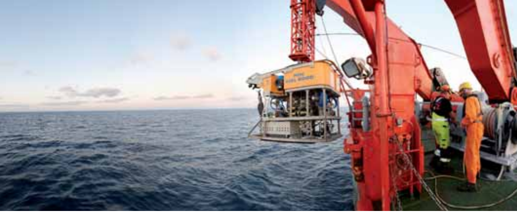
Der ferngesteuerte Tiefseeroboter ROV KIEL 6000 wird vom deutschen Forschungsschiff SONNE aus im Ostpazifik eingesetzt. Er gehört zu den weltweit wenigen Geräten dieser Art, die mehr als 90 Prozent der Meeresböden erkunden können. Foto: B. Grundmann
