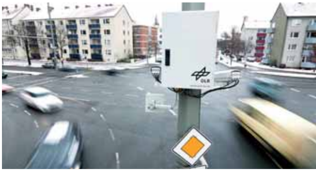
An einer vielbefahrenen Kreuzung in Braunschweig untersuchen DLR-Verkehrsforscher, wie Autofahrer untereinander sowie mit Fußgängern und Radfahrern interagieren. Ziel ist herauszufinden, warum es zu kritischen Situationen kommt und wie diese mit Fahrerassistenzsystemen entschärft werden können. Foto: Jenoptic/DLR
