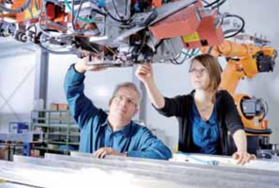
Wird im HZG erforscht: Laserstrahlschweißen von Leichtbau-Legierungen. Foto: HZG/C. Schmid
