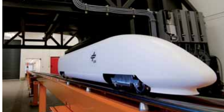
Das Fahrverhalten künftiger Hochgeschwindigkeitszüge lässt sich in der Tunnelsimulationsanlage im DLR Göttingen erforschen. Foto: DLR
