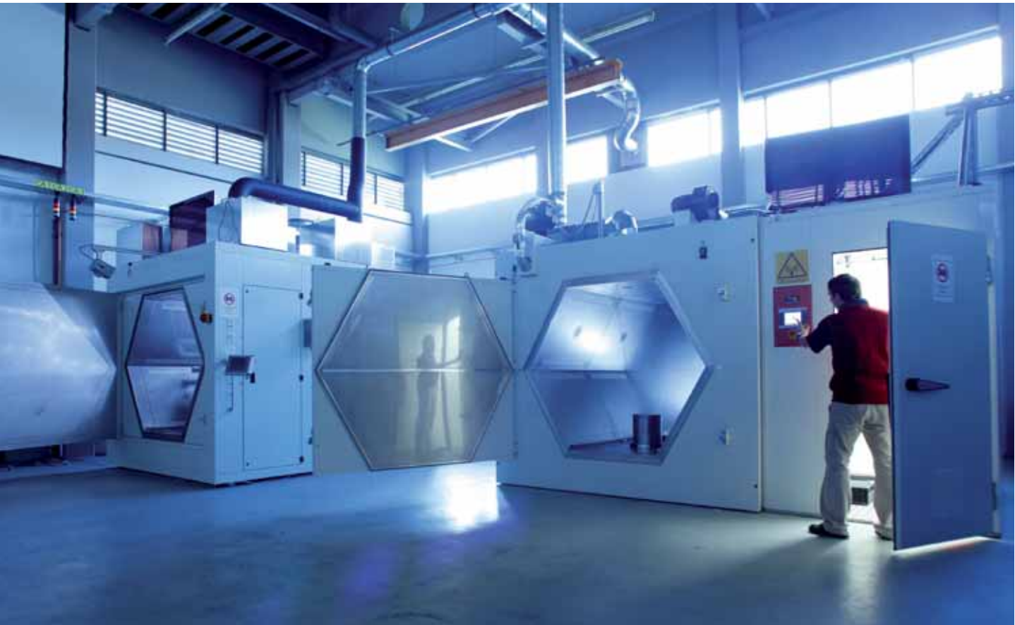
Mikrowelle HEPHAISTOS: Rund 7.000 Liter fasst die sechseckige Mikrowelle mit optimierter Geometrie. Foto: KIT/T. Wegner
