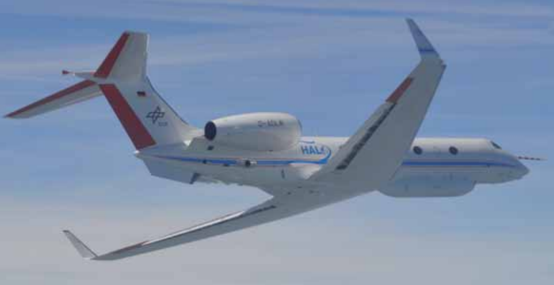
Das Atmosphärenforschungsflugzeug HALO (High Altitude and Long Range Research Aircraft): Dank einer Reichweite von mehr als 8.000 Kilometern sind erstmals Messungen auf der Skala von Kontinenten möglich. Für unterschiedliche Messungen kann das Flugzeug unter dem Rumpf und den Tragflächen zusätzliche Behälter für wissenschaftliche Instrumente aufnehmen. Foto: DLR
