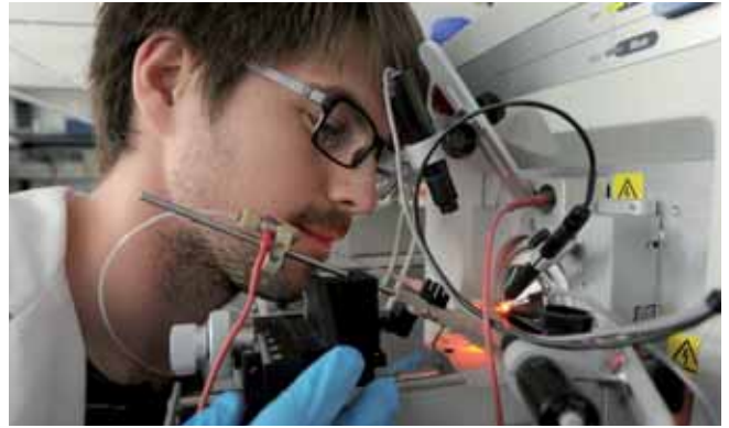
Bereits geringe Proteinmengen können identifiziert und quantifiziert werden: Ein Wissenschaftler am MDC justiert die Position der Nano-HPLC-Säule. Diese fraktioniert die Peptide, bevor sie im Massenspektrometer gemessen werden. Foto: MDC/D. Ausserhofer
