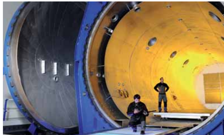
Der größte Forschungsautoklav der Welt steht im DLR Stade. Mit ihm härten die Wissenschaftler Flugzeugbauteile aus kohlestofffaserverstärktem Kunststoff (CFK) aus. BALU (Biggest Autoclave Laboratory Unit) wurde 2012 in Betrieb genommen und ist 20 Meter lang bei einem Durchmesser von nahezu sechs Metern. Foto: DLR
