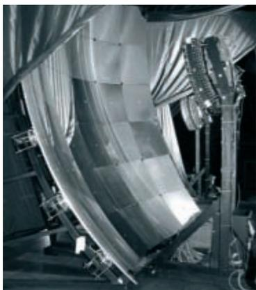
Bild FZK: Teleskope wie dieses ergänzen die Wasserdetektoren des Pierre Auger-Observatoriums. Sie beobachten Fluoreszenzlicht in der Atmosphäre.
