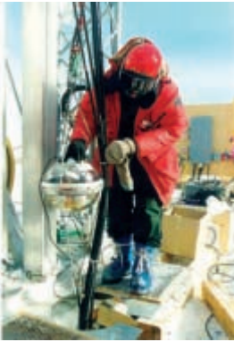
Bild DESY: Die „Augen“ von AMANDA sind druckfeste Glaskugeln mit einem Lichtverstärker, versenkt in kilometertiefe Bohrlöcher in der Antarktis.
