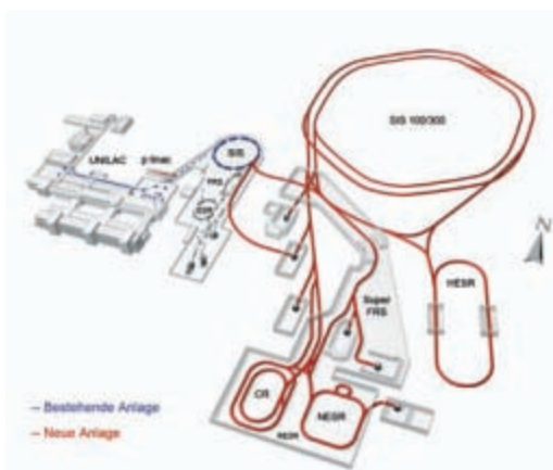
Bild GSI: Das Herzstück von FAIR (rot) ist eine Synchrotron-Doppelringanlage, an die sich Kühl- und Speicherringe sowie die Experimentierhallen anschließen. Die bestehende GSI-Anlage (blau) wird als Injektor für FAIR dienen.
