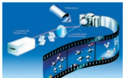
Grafik DESY: Der Röntgenlaser XFEL wird es ermöglichen, chemische Reaktionen „filmisch“ aufzulösen. Dazu braucht man intensive Röntgenpulse, die nur milliardstel Sekunden lang sind.
