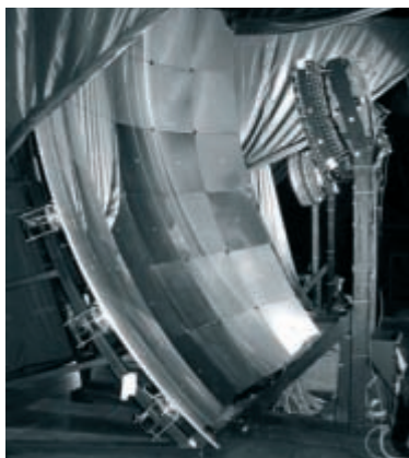
Bild FZK: Teleskope wie dieses ergänzen die Wasserdetektoren des Pierre Auger-Observatoriums. Sie beobachten Fluoreszenzlicht in der Atmosphäre.
