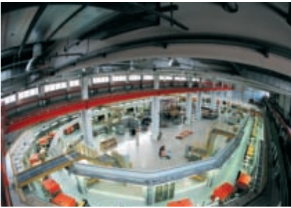
Bild FZJ: Cosy ist ein 184 Meter langer ovaler Cooler-Synchrotron. Hier prallen Protonen in einem gigantischen Teilchen-Crash mit nahezu Lichtgeschwindigkeit auf ein Target.
