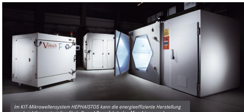
Im KIT-Mikrowellensystem HEPHAISTOS kann die energieeffiziente Herstellung von Leichtbaumaterialien für Luft- und Raumfahrt, den Maschinen- und Anlagenbau, die Windenergietechnik und Medizintechnik erforscht werden.
