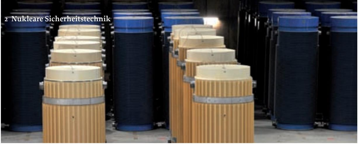
Behälter zur sicheren Aufbewahrung radioaktiver Reststoffe.
