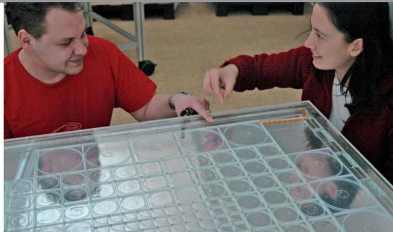
EINE VON 40 SCHICHTEN FÜR DEN PROTOTYP DES ENERGIESENSORS: DIE „AUGEN“ BESTEHEN AUS KUNSTSTOFFSCHEIBEN, DIE DIE TEILCHENENERGIE IN LICHT UMWANDELN. Foto: DESY
