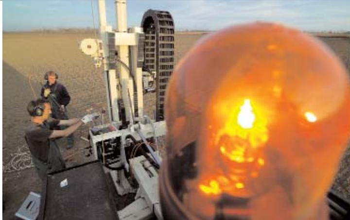
MIT EINEM DIRECT-PUSH-GERÄT WERDEN DIE TIEFENPROFILE VON STOFFKONZENTRATIONEN IM GRUNDWASSER GEMESSEN.
