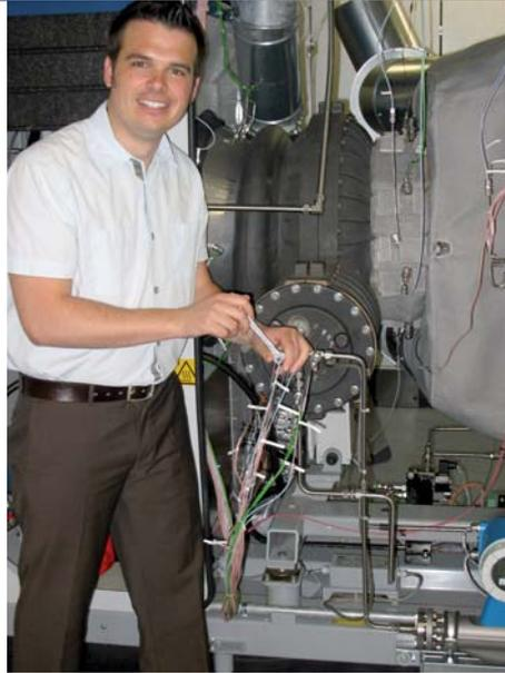
AXEL WIDENHORN KOMBINIERT GASTURBINEN MIT BRENNSTOFFZELLEN UND KANN SO DEN WIRKUNGSGRAD EINES KRAFTWERKBLOCKS AUF 60 PROZENT ERHÖHEN. Foto: DLR
