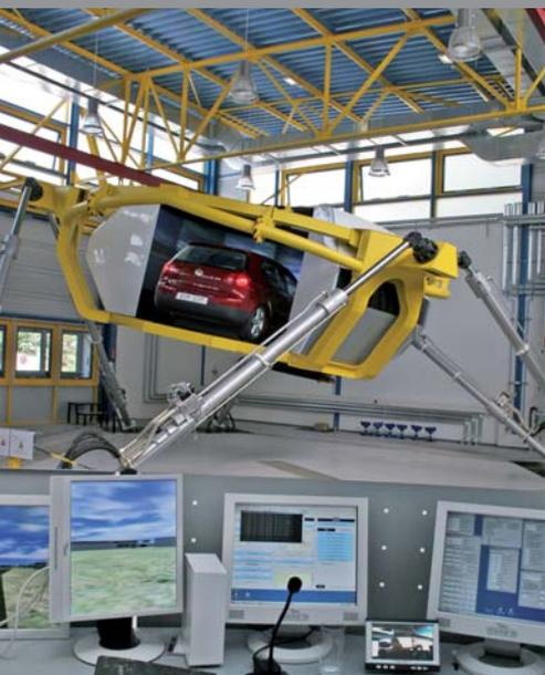
AM FAHRSIMULATOR MIT LEITSTAND KÖNNEN DIE PSYCHOLOGEN TESTEN, WELCHE ASSISTENZSYSTEME DIE FAHRER SINNVOLL UNTERSTÜTZEN. Foto: DLR
