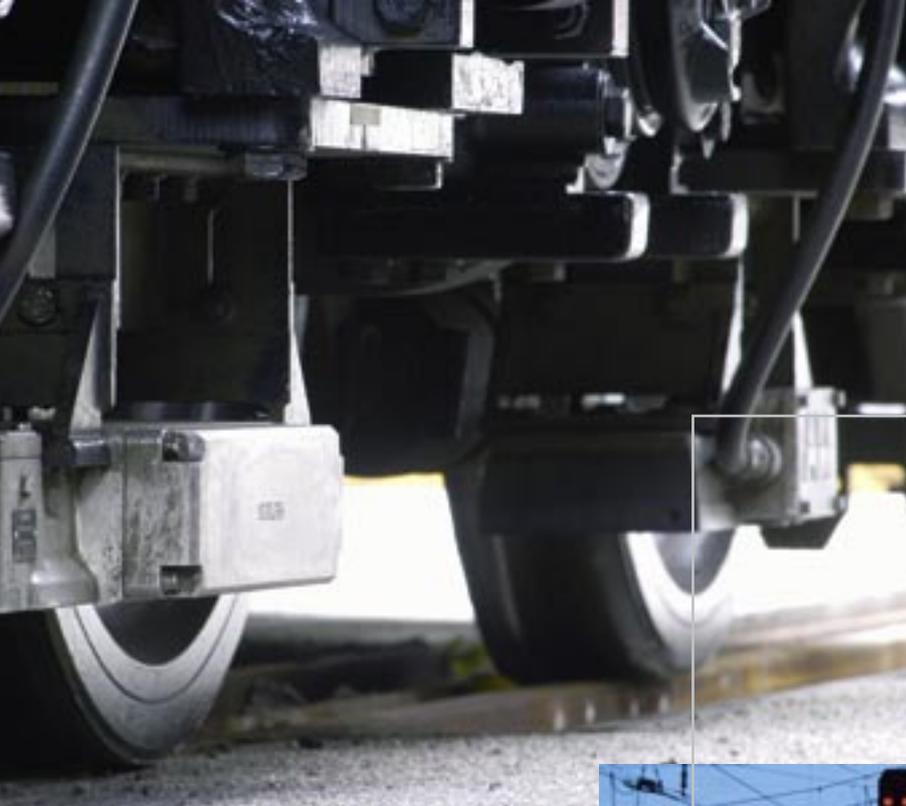
Räder und Drehgestellrahmen der Lokomotive Class 66 kommen von General Motors. Im Vordergrund als silberne Box zu erkennen: eine Indusi-Antenne von Siemens für den Einsatz in Deutschland, Österreich und Slowenien. Im Hintergrund: eine Antenne von ABB für ein anderes System. Bis zu 24 solcher Antennen müssen unter einer Lok montiert sein, wenn sie überall in Europa mit den schienenseitigen Systemen kompatibel sein soll.
