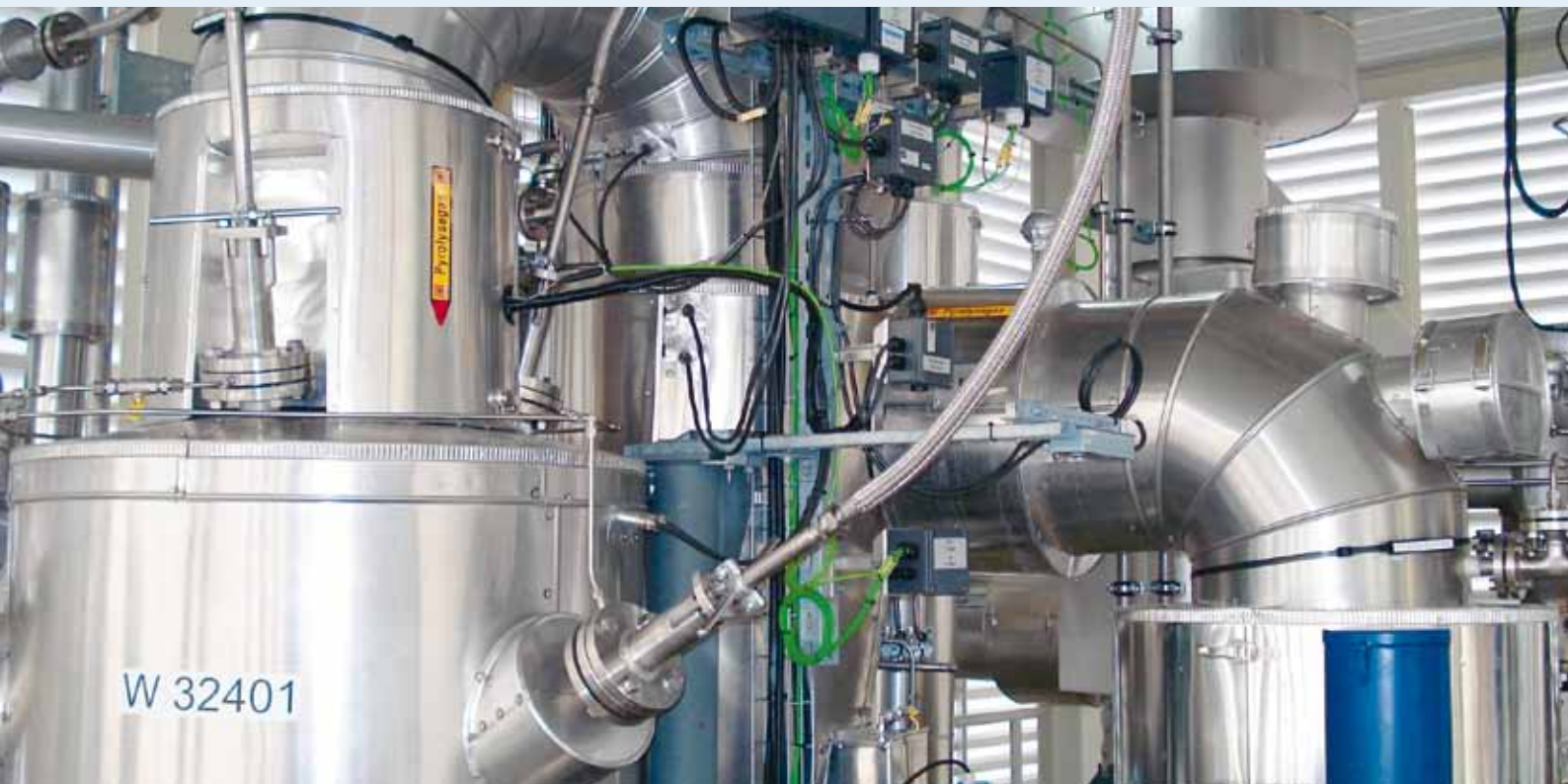
AUF DEM CAMPUS NORD DES KIT WIRD DIE BIOLIQ-PILOTANLAGE AUS STROH UND ANDEREN RESTSTOFFE ZUNÄCHST EIN ÖLÄHNLICHES VORPRODUKT UND DARAUS DANN MASSGESCHNEIDERTE DESIGNERKRAFTSTOFFE PRODUZIEREN. Foto: KIT
