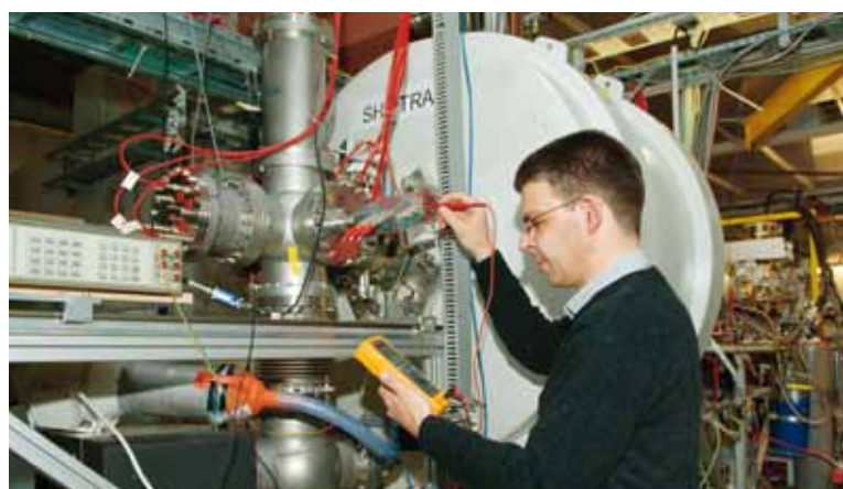
AN DER IONENFALLE SHIPTRAP WURDE DIE MASSE DES KÜNSTLICHEN ELEMENTS 102, NOBELIUM, MIT HÖCHSTMÖGLICHER PRÄZISION GEMESSEN. Foto: GSI/G. Otto
