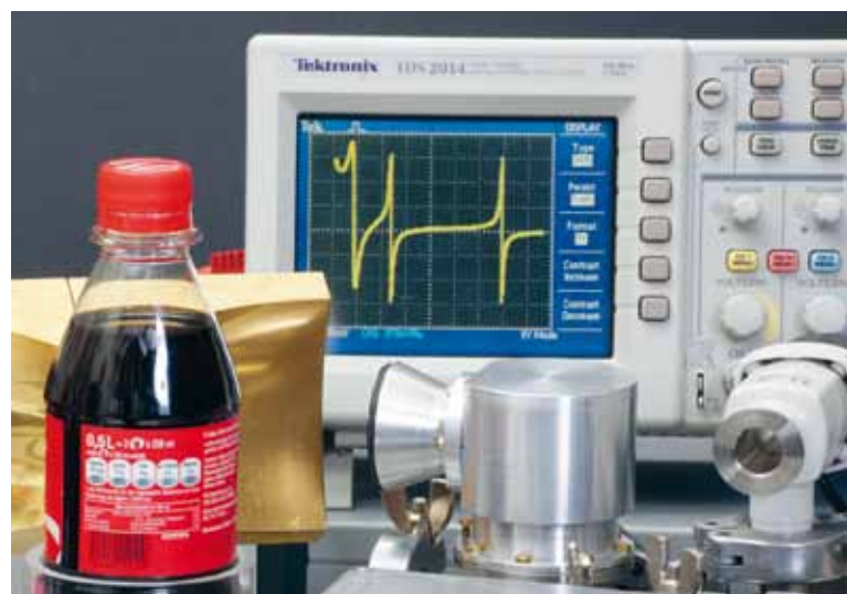
DER AUFBAU ZEIGT DEN PROTOTYPEN DES DETEKTORS (MITTE) UND DIE ZU UNTERSUCHENDE FLÜSSIGKEIT IN EINER FLASCHE. DIE LICHTQUELLE BEFINDET SICH LINKS AUSSERHALB DES BILDES. Foto: Forschungszentrum Jülich
