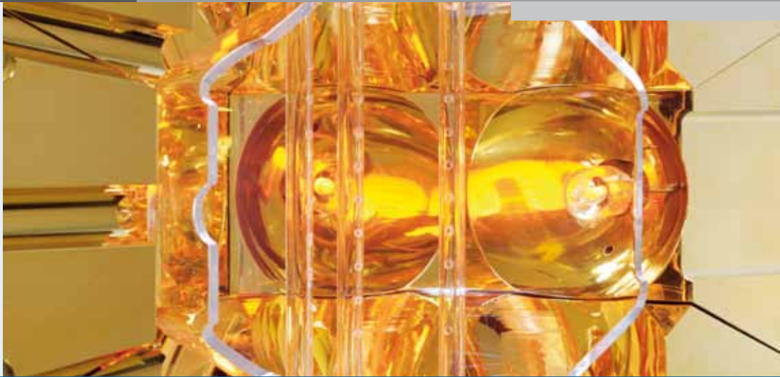
IM STRAHLUNGSOFEN WERDEN HOCHTEMPERATURWERKSTOFFE ERFORSCHT UND GEPRÜFT, DIE DIE EFFIZIENZ VON KRAFTWERKEN VERBESSERN KÖNNTEN. Foto: FZJ
