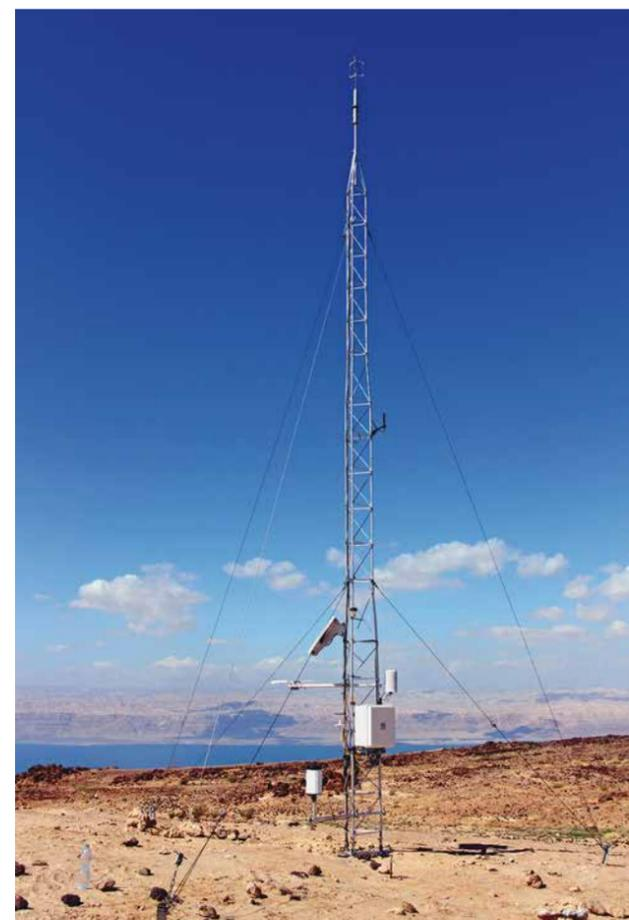
Meteorologischer Messmast westlich von Madaba (Jordanien). Im Hintergrund das Tote Meer. Seit März 2014 werden Windgeschwindigkeit und Windrichtung, Lufttemperatur, relative Feuchte, kurzwellige und langwellige Strahlungsbilanz, Luftdruck, Niederschlag, Bodenwärmestrom, Bodentemperatur und Bodenfeuchte erfasst. © Friederike Lott, KIT
