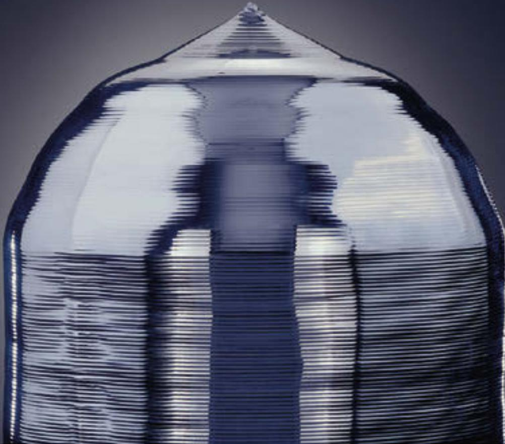
**Ästhetischer Rohstoff** Besonders reine Silizium-Kristalle werden zum Beispiel für Solarzellen benötigt, ihre Herstellung verschlingt aber viel Energie.
