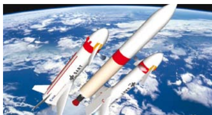
Nachdem sie ihre Funktion erfüllt haben, sollen die Hilfsraketen in Zukunft abgetrennt werden und zum Startplatz zurückkehren. Bild: DLR
