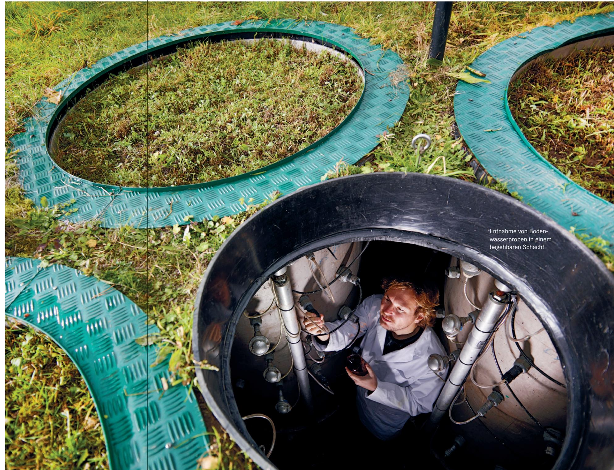
Entnahme von Bodenwasserproben in einem begehbaren Schacht
