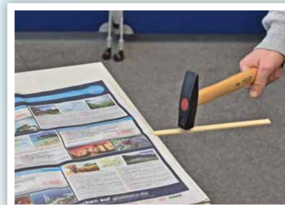
Nun werden mehrere Blätter Zeitungspapier über die Holzleiste gelegt. Nun wird wieder ruckartig auf die Leiste geschlagen.
