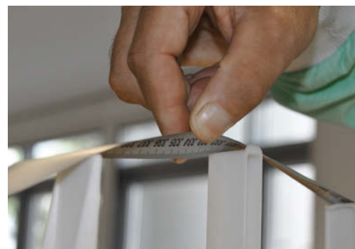
Clevere Details Die Miniatur-Schubdüse zum Manövrieren (links), mehrlagige Temperatur-Schutzfolien und die Bandmaß-Antenne (rechts). Bilder: Andreas Spaeth
