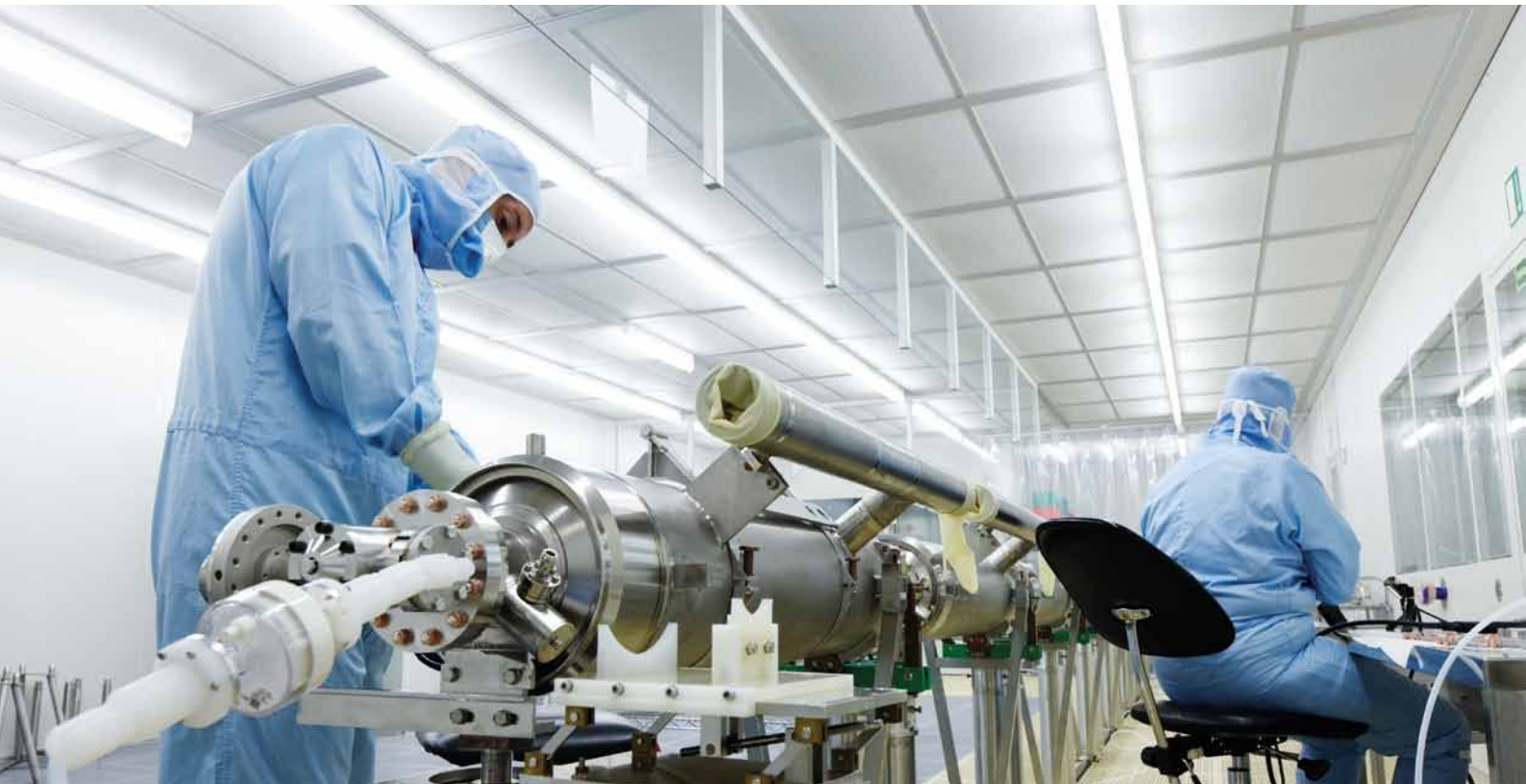
Sauber ist nicht genug In Reinräumen montieren Wissenschaftler zum Beispiel supraleitende Beschleunigermodule. Bild: DESY
