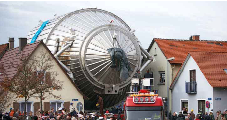
Passgenau Der 200 Tonnen schwere, 24 Meter lange und 10 Meter breite Vakuumentank für KATRIN wurde 2006 präzise durch Leopoldshafen zum KIT-Campus Nord transportiert. Bild: Markus Breig/KIT
