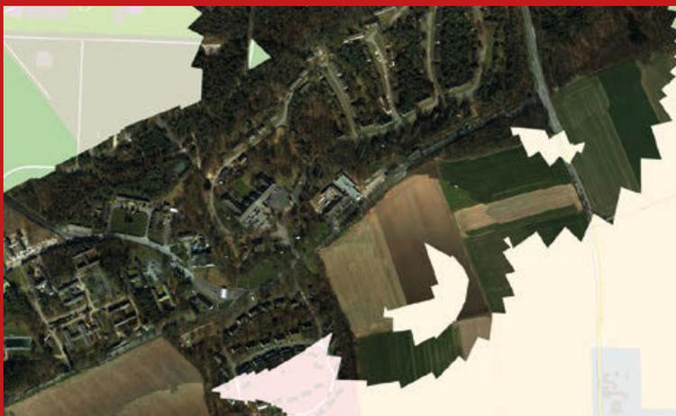
**Luftbildaufnahmen des automatischen Überflugs** Die interaktive Karte ist direkt nach der Landung verfügbar und kann durch I.S.A.R. Germany zur Lageaufklärung verwendet werden. Die Flughöhe betrug 250 Meter. Das Fluggebiet hat eine Ausdehnung von 1,5 Kilometern. Die Bodenauflösung beträgt fünf Zentimeter.
