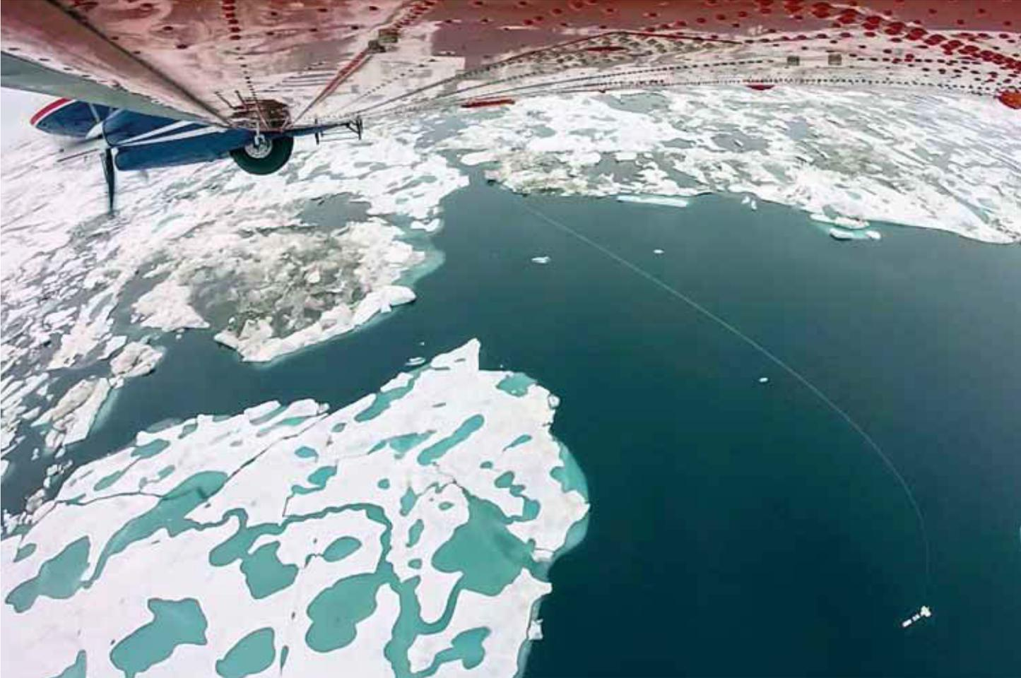
**Überflogen** Die Sonde „EM-Bird“ wird vom Rumpf eines Flugzeugs mit einer Winde herabgelassen und fliegt an einem langen Stahlseil über das Meereis, um dessen Dicke zu messen. Bild: Esther Horvath
