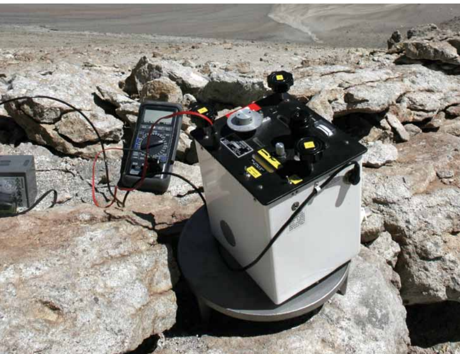
Vulkanvorhersage Die GPS-Bodenstation misst örtliche Hebungen und ein Schweresensor ortet unterirdische Magmen. Bild: GFZ
