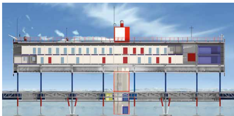
Längsschnitt durch die Station Wohn-, Arbeits- und Technikräume liegen oberhalb – Garage und Lagerräume unterhalb der Eisoberfläche. Bild: AWI
