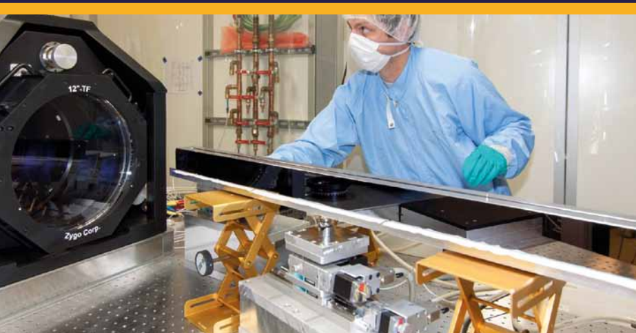
European XFEL-Röntgenspiegel European XFEL-Wissenschaftler Maurizio Vannoni prüft den neuen Röntgenspiegel, dessen Oberfläche nicht mehr als einen milliardstel Meter von der Idealform abweicht. Bilder: European XFEL
