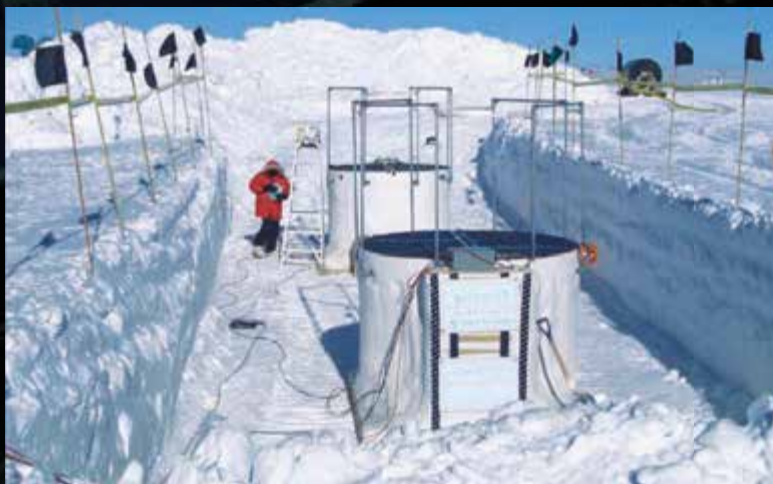
Fertig installierter IceTop-Tank Mit den IceTop-Detektor-Tanks werden Teilchenschauer gemessen, die von hochenergetischer kosmischer Strahlung in der Atmosphäre erzeugt werden. Bild: IceCube Collaboration
