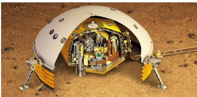
**Empfindlich** Das Seismometer SEIS registriert auch kleinste Bewegungen im Marsboden und besteht aus insgesamt sechs Sensoren. Bild: IPGP/N. Sarter
