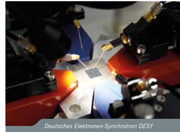
Die Eigenschaften der mikrostrukturierten Sensorschichtsysteme lassen sich für vielfältige Anwendungen etwa in der Computer- und Autoindustrie maßschneidern. Foto: Kai Schlage/DESY
