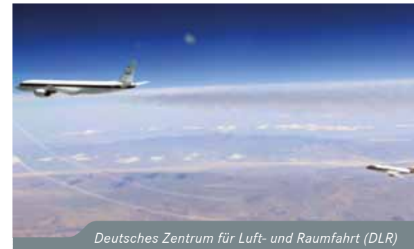
Hinter der DC-8 messen die Wissenschaftler an Bord der DLR-Falcon die Abgaszusammensetzung. Foto: NASA
