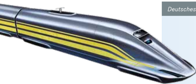
Flexibles Zugkonzept: Die Einzelwagen bilden einen Verband und werden mit ein oder zwei Triebköpfen zu einem vollständigen Triebwagenzug zusammengestellt. Bild: DLR
