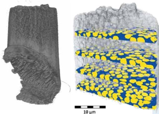
Nanotomographie-Experimente an der HZG-Beamline P05 an PETRA III: Rekonstruiertes (l.) und segmentiertes (r.) Volumen einer Probe aus photonischem Zirkonia-Glas. Bild: HZG
