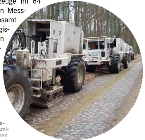
Die 21 Tonnen schweren Vibrationsfahrzeuge erzeugten seismische Wellen, die von Geophonen aufgezeichnet wurden. Bild: GGD
