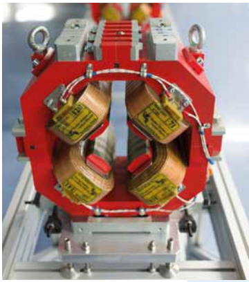
Die Quadrupolmagnete wurden am Budker-Institut in Novosibirsk produziert. Bild: M. Setzpfand/HZB
