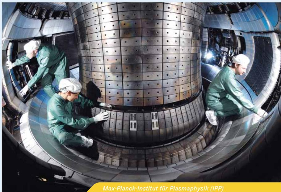
Blick in das Plasmagefäß der Fusionsanlage ASDEX Upgrade in Garching.
