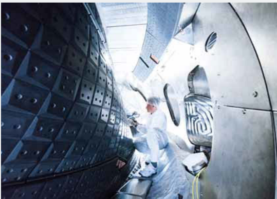
Blick in das mit Grafitkacheln verkleidete Plasmagefäß der Fusionsanlage Wendelstein 7-X. Bild: IPP, Jan Michael Hosan
