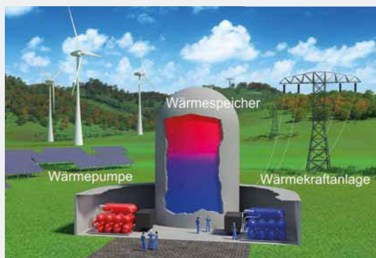
Carnot-Batterien sind zyklensfeste Strom-Wärme-Strom-Speicher zur Speicherung großer Elektrizitätsmengen. Bild: DLR (CC-BY 3.0)
