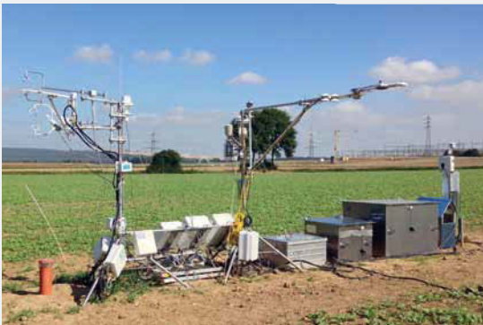
Mit der Forschungsinfrastruktur ICOS kann der Austausch von Treibhausgasen zwischen Böden und Atmosphäre untersucht werden. Bild: Forschungszentrum Jülich
