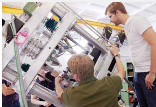
Das zu untersuchende Blech wird unter dem Schweißkopf eingespannt und kann von einem Röntgenstrahl während des Schweißens durchdrungen werden. Bild: C. Schmid/HZG
