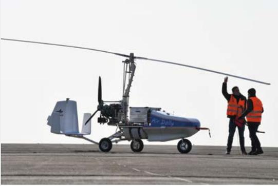
Der ALADy-Demonstrator, ein auf einem bemannten System basierendes unbemanntes Luftfahrzeug. Bild: DLR
