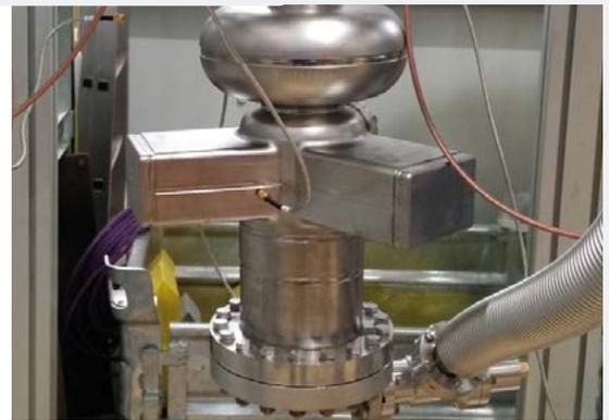
Prototyp einer einzelligen Kavität, die bei 1,8 Kelvin (-271 Grad Celsius) getestet wurde. Bild: HZB
