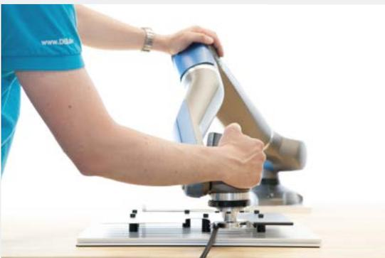
Der Leichtbauroboter SARA lernt von seinem Bediener. Bild: DLR
