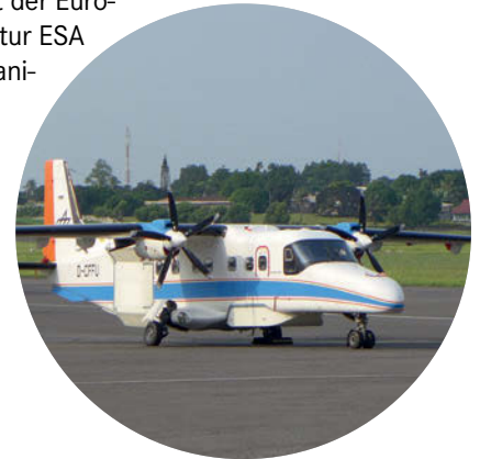
Die zweimotorige Turbo-propeller-Maschine Do 228-212 eignet sich durch ihre rechteckige Kabine und die großen Öffnungen im Boden besonders gut zur Installation von speziellen Kamera- und Radarsystemen. Bild: DLR (CC BY 3.0)
