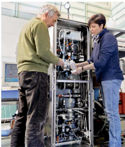
Dr. Wilhelm Petersen und Martina Gehring bei der Kalibrierung einer FerryBox. Bild: HZG
