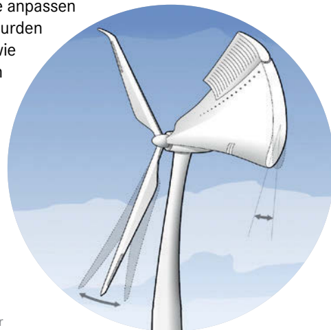
Bewegliche Hinterkanten und Vorflügel machen Rotorblätter flexibel. Bild: DLR (CC BY 3.0)
