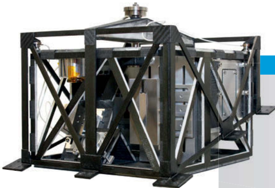
Nur so groß wie ein Schuhkarton ist der Lander MASCOT. Er soll vier Instrumente auf den Astroiden Ryugu bringen. Bild: DLR (CC-BY 3.0)
