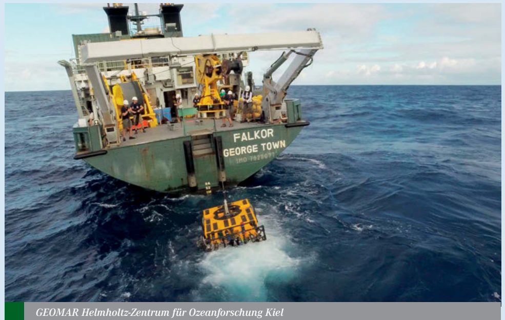
Der Tiefseeroboter ROPOS tritt mit dem am GEOMAR entwickelten Kamerasystem den Weg in die Tiefe an. Bild: Björn Kurtenbach
