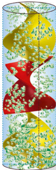
Statische Mischer, wie hier grafisch dargestellt, sollen direkt in Rohrsystemen Strömungen vermischen. Bild: Michael Voigt/HZDR
