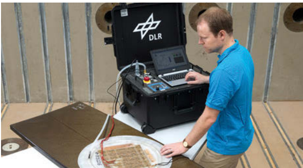
Mithilfe einer mobilen Reparaturstation lassen sich Strukturen aus faserverstärkten Kunststoffen schnell und effizient flicken. Bild: DLR/Frank Eppler
