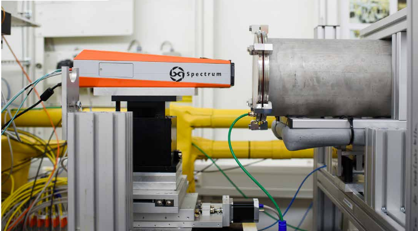
Ein Detektor der DESY-Ausgründung X-Spectrum an der Beamline P11 an PETRA III.
