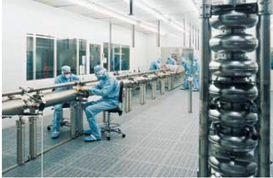
Die supraleitenden Beschleunigungsstrukturen von TESLA werden in einem nahezu staubfreien Reinraum bearbeitet und montiert.
