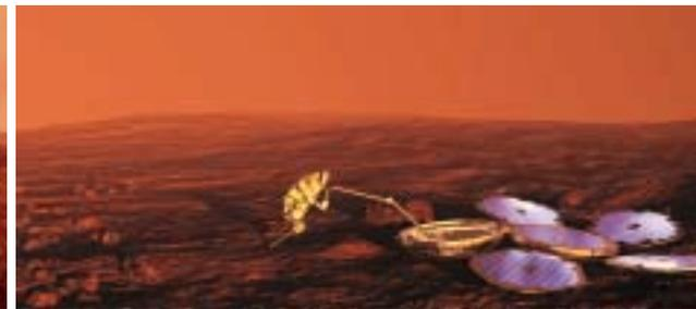
*Nach dem Aufprall auf der Marsoberfläche trennen sich die drei bremsenden Gassäcke vom Lander (links). Auf den beiden mittleren Bildern ist der Greifarm des Landers gut zu erkennen. Auf ihm ist PLUTO (rechts) installiert; der „Maulwurf“ nimmt Bodenproben aus verschiedenen Tiefen.*
