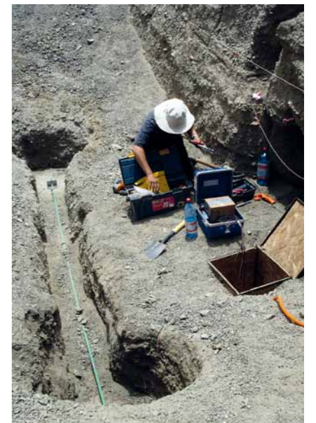
Ein Creepmeter im Norden Chiles misst tektonische Verschiebungen mit einmaliger Präzision.
