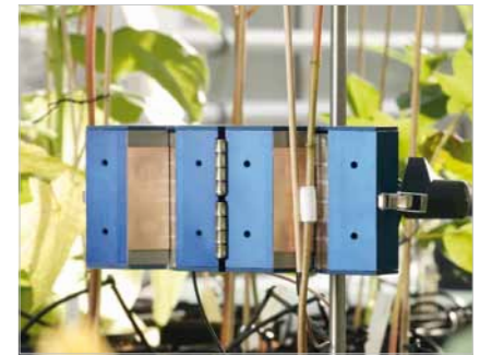
Kernspin für Pflanzen: Ein tragbares Magnetresonananzgerät (NMR) misst den Stofftransport.
