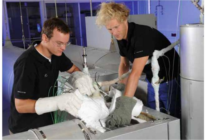
DLR-Wissenschaftler überprüfen den Temperaturverlauf an einem thermochemischen Versuchsspeicher. Foto: DLR (CC-BY 3.0)
