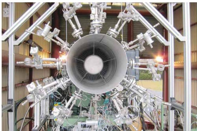
Für die DLR-Messkampagne zur Triebwerksakustik wurde eine Reihe von Mikrofonen an verschiedenen Stellen innerhalb und im Austrittsbereich des Triebwerks montiert, die jeweils zur gleichen Zeit Signale aufnehmen. Foto: DLR (CC-BY 3.0)
