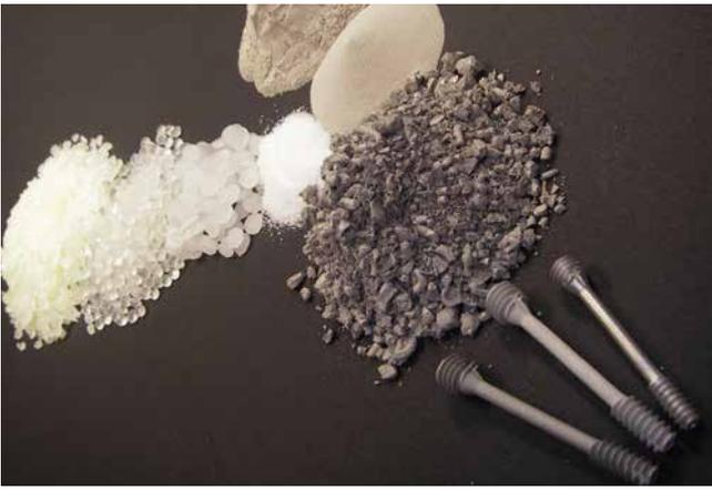
Metallpulver-Spritzgießen: Oben rechts die Metallpulver, links Polymerkomponenten, mittig das gemischte Granulat. Unten: Bauteil-Vorstufen sowie die fertige Mg-Ca-Knochenschraube rechts. Foto: M. Wolff/HZG
