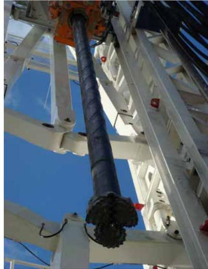
Tiefbohranlage InnovaRig (links) und Rollenmeißel am Kopf des Bohrgestänges der InnovaRig. Fotos: GFZ
