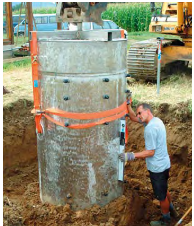
EIN LYSIMETER ENTHÄLT RUND 1,5 KUBIKMETER BODEN UND ZAHLREICHE MESSGERÄTE. Foto: Firma Umweltmonitoringsysteme
