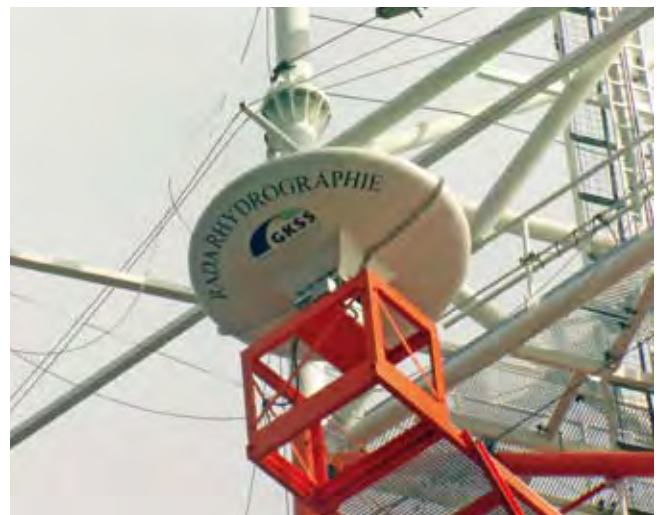
DAS WELLENRADAR DER GEESTHACHTER KÜSTENFORSCHER AUF DER MESSPLATTFORM FINO3. Foto: F. Ziemer, GKSS
