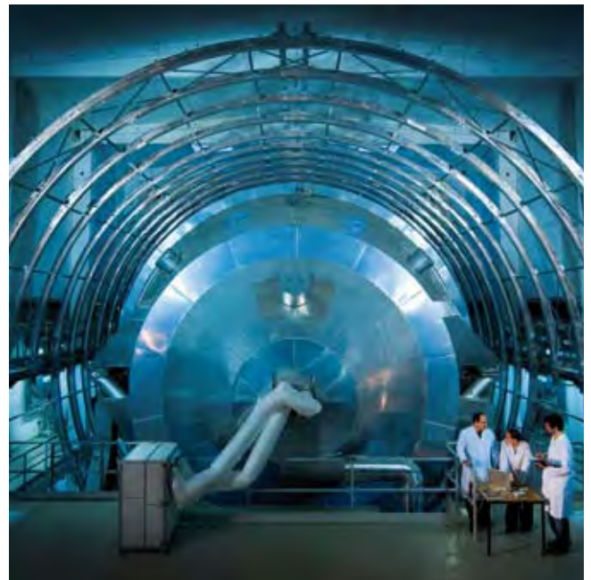
DAS KATRIN-SPEKTROMETER IST VON 15 GROSSEN RINGEN UMGEBEN, DIE DIE SPULEN ZUR ERZEUGUNG DES MAGNETISCHEN FÜHRUNGSFELDES TRAGEN. Foto: KIT
