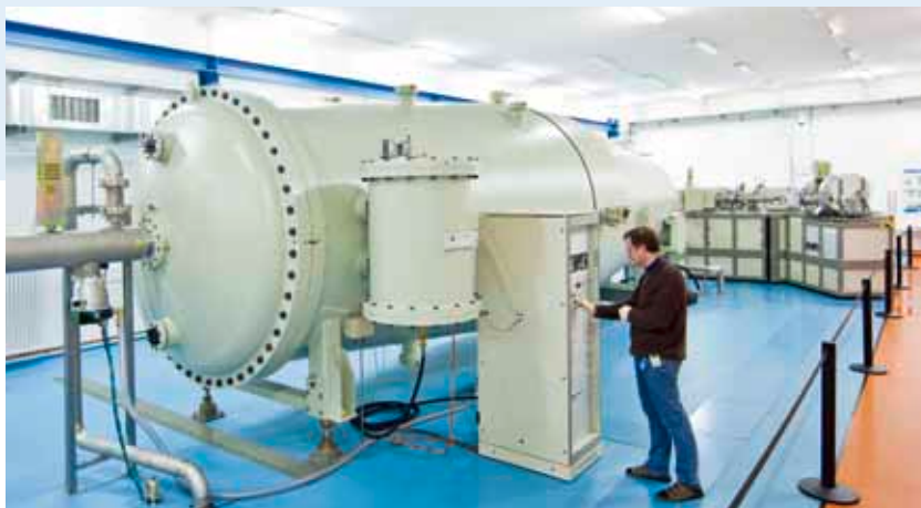
Zur Herstellung der Quantenpunkte aus Indiumarsenid verwenden die Wissenschaftler die Ionenbeschleuniger im Ionenstrahlzentrum des HZDR. Das Bild zeigt den 6-Megavolt-Ionenbeschleuniger, der von der EU im EFRE-Programm gefördert wurde. Foto: Oliver Killig/HZDR
