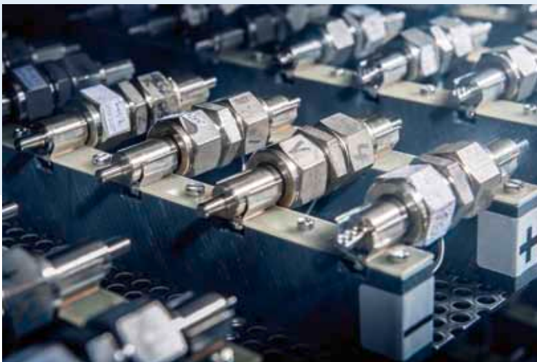
Unter kontrollierten Temperaturbedingungen werden die einzelnen Batteriezellen getestet. Foto: KIT
