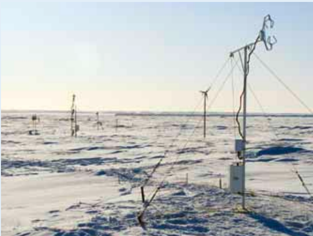
Diese Messeinrichtung erfasst den Austausch von Energie- und Stoffströmen zwischen tiefer und höher gelegenen Luftschichten über dem Boden. Foto: Günther Stoof/AWI
