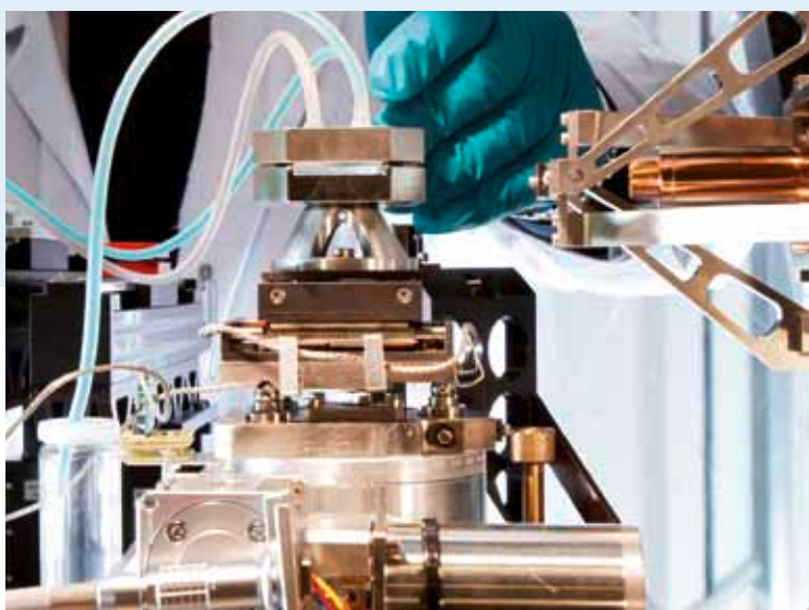
Mit diesem Experimentaufbau werden spezielle Schichten in den Solarzellen hergestellt, die anschließend mit Goldatomen kontaktiert werden. Foto: Heiner Müller-Elsner/DESY
