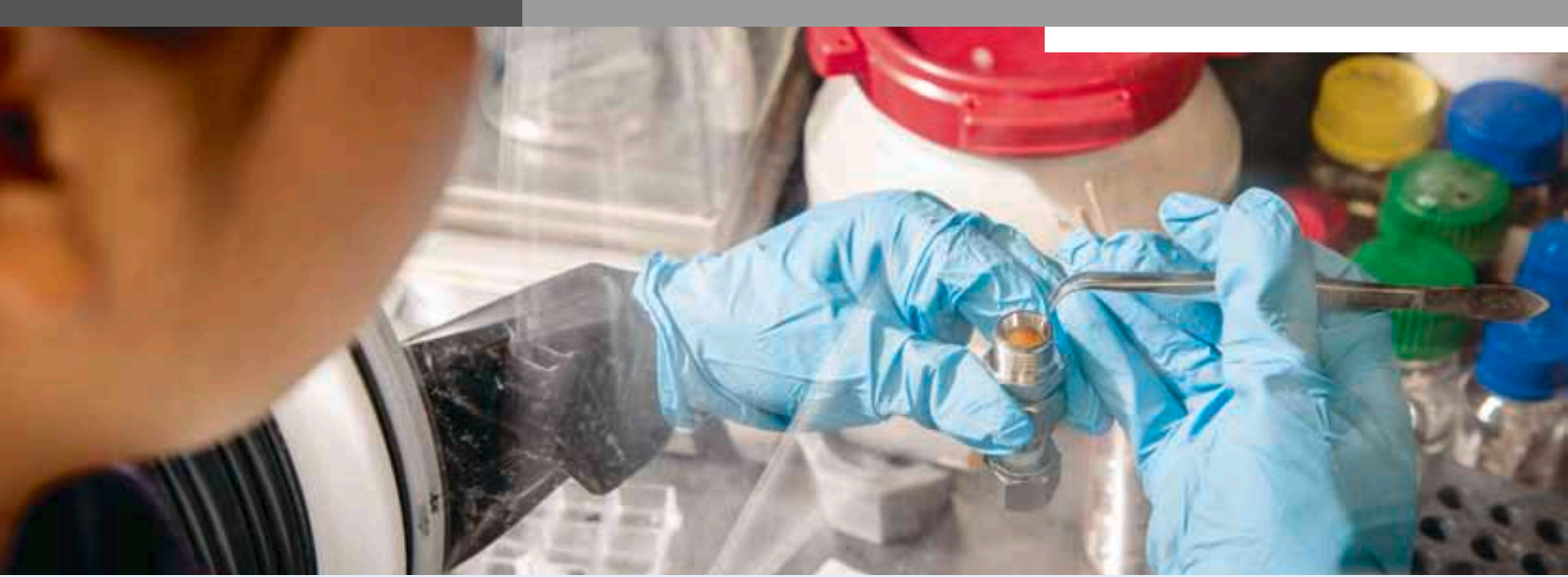
Eine Wissenschaftlerin beim Zusammenbau einer Testzelle in einer Handschuhbox unter Schutzgasatmosphäre, die ungewünschte Reaktionen verhindert. Foto: KIT
