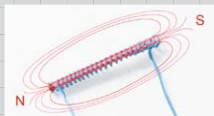
Abb. oben: Alexander und Katharina haben einen Elektromagneten gebaut. Sie halten ihn an einen Kompass. Abb. unten: Die einzelnen Windungen des Drahtes bilden zusammen ein Magnetfeld, das z.B. eine Büroklammer anziehen kann.
