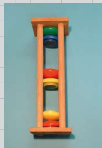
Das selbst gebaute Gravimeter: So zeigt es Schwerelosigkeit an.
