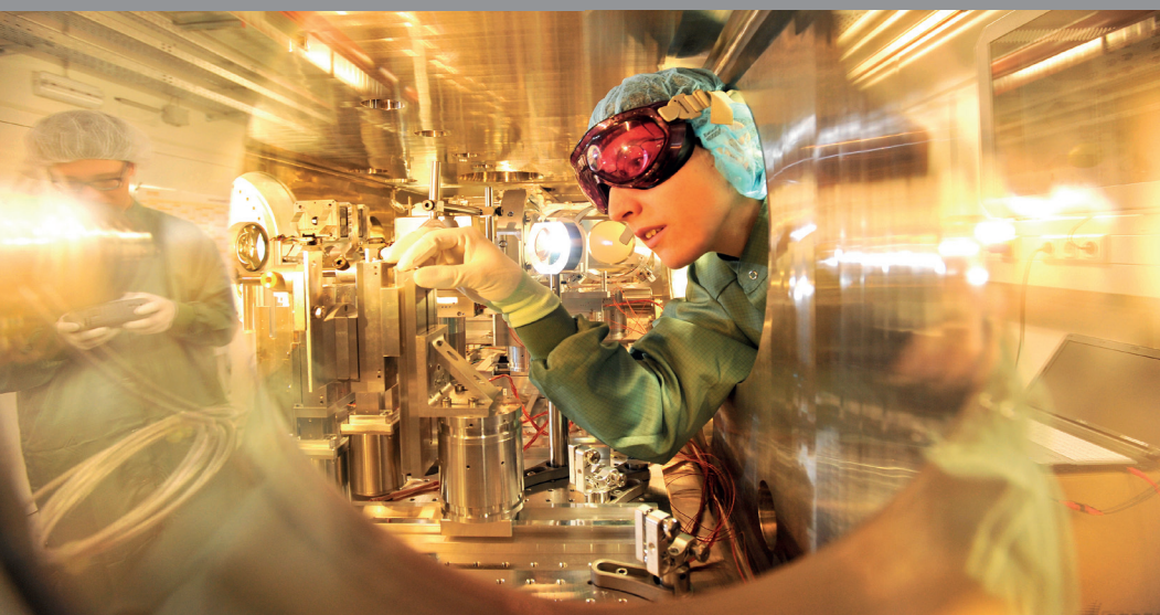
Laser-Teilchenbeschleunigung in der ELBE - Zentrum für Hochleistungs-Strahlenquellen am HZDR: In dieser Kammer trifft der Lichtstrahl des Hochleistungslasers auf den Elektronenstrahl des ELBE-Beschleunigers. Ziel ist die Erzeugung brillanter Röntgenstrahlung. Bild: HZDR/Frank Bierstedt
