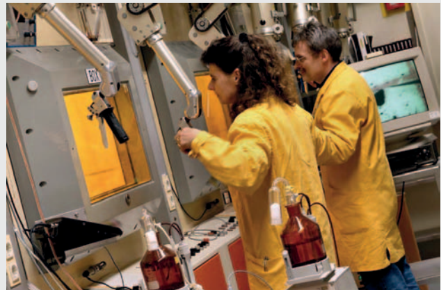
Dicke Bleiglasscheiben schützen die Experimentatoren vor der Strahlung der radioaktiven Präparate. Das KIT betreibt das derzeit größte deutsche Versuchsfeld zum Rückbau kerntechnischer Anlagen.
