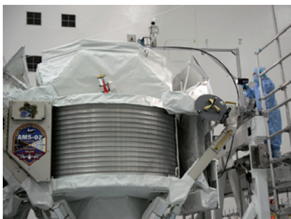
Fast sieben Tonnen schwer und vier Meter hoch ist das Alpha-Magnet-Spektrometer, das die kosmische Strahlung messen soll. Bild: NASA
