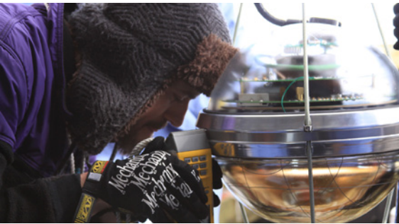
Vor dem Versenken ins Eis werden die Sensoren noch einmal überprüft. Foto: DESY
