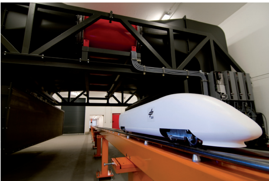
In der neuen Tunnelsimulationsanlage im Deutschen Zentrum für Luft- und Raumfahrt (DLR) in Göttingen wird das Fahrverhalten von Hochgeschwindigkeitszügen unter realistischen Bedingungen getestet. Foto: DLR
