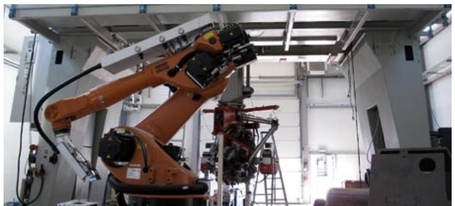
Die neue Laserschweißanlage für Flugzeugbauteile.
