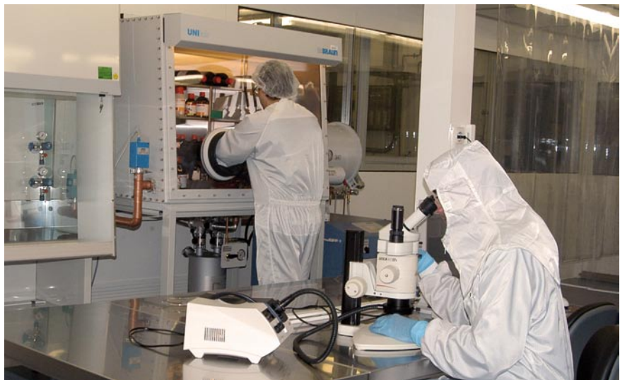
In Reinräumen stellen Forscher keramische Membranen her, die in der Lage sind, Gasgemische zu trennen. In Kraftwerksprozessen eingesetzt, können Keramiken helfen, den Ausstoß von Kohlendioxid zu senken. Foto: Forschungszentrum Jülich
