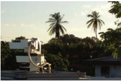
Einer der drei Messcontainer an der Tropenstation in Surinam. Der Sonnensucher auf dem Dach des Containers, welcher dem Lauf der Sonne folgt, lenkt das Sonnenlicht zur Vermessung der Atmosphäre in das Spektrometer.
