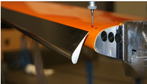
Turbulenzen im Griff Das neu entwickelte Landeklappensystem garantiert eine turbulenzarme Strömung. Bild: DLR (CC-BY 3.0)
