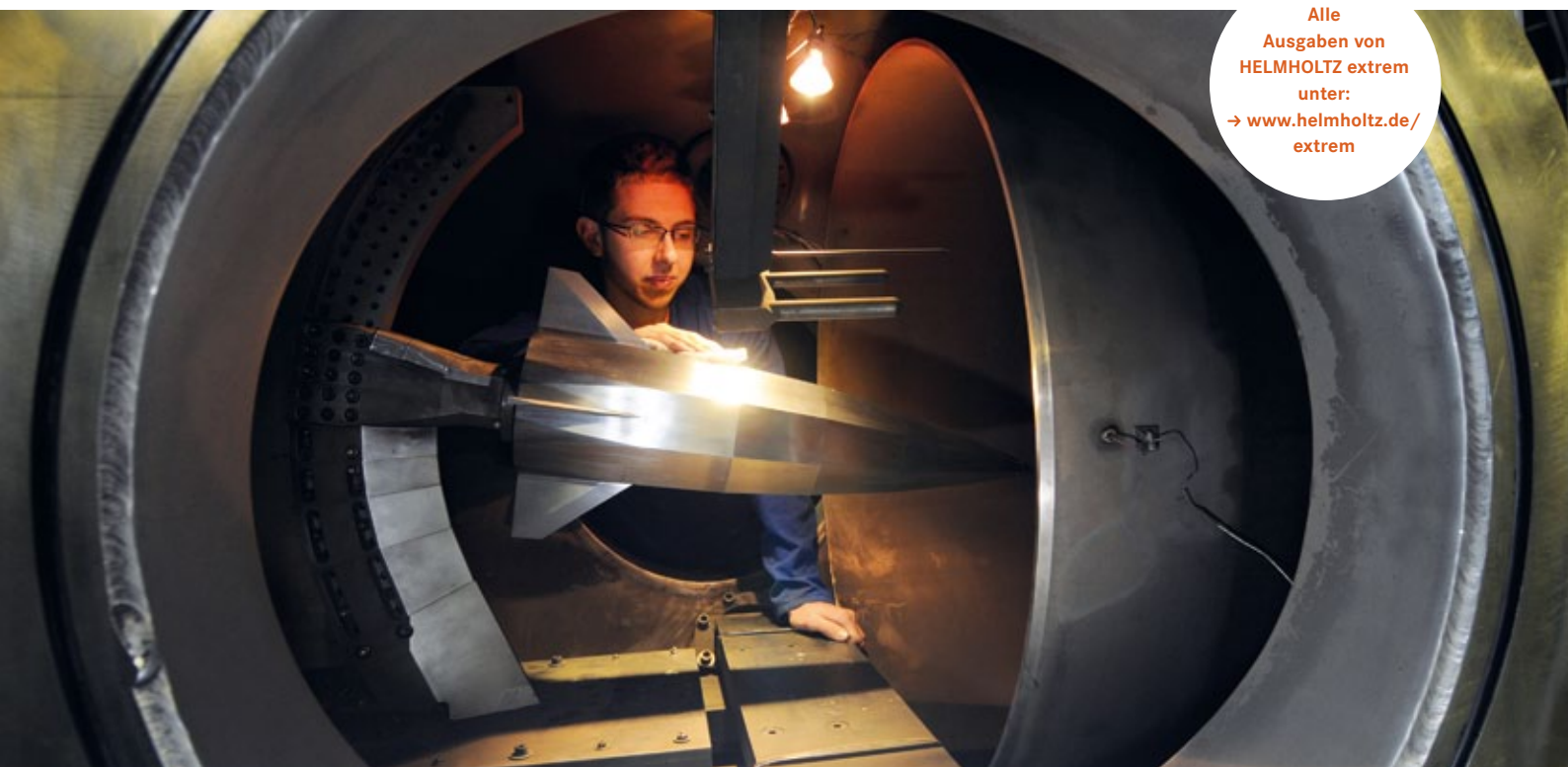
Windige Umgebung Mithilfe des Modells eines Raumfahrzeuges simulieren Göttinger Forscher den Wiedereintritt in die Erdatmosphäre. Foto: DLR
