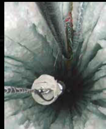
Absenken einer Akustiktrosse in ein IceCube-Bohrloch Der South Pole Acoustic Test Setup (SPATS) soll die Eiseigenschaften für die akustische Signalübertragung prüfen.
