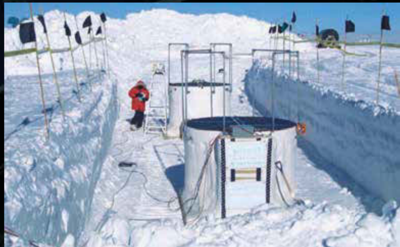
Fertig installierter IceTop-Tank Mit den IceTop-Detektor-Tanks werden Teilchenschauer gemessen, die von hochenergetischer kosmischer Strahlung in der Atmosphäre erzeugt werden. Bild: IceCube Collaboration
