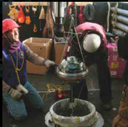
Installation eines optischen Moduls Ein optisches Modul wird an der Kabeltrosse befestigt, mit der es in das frisch geschmolzene Bohrloch versenkt wird. Bilder: DESY
