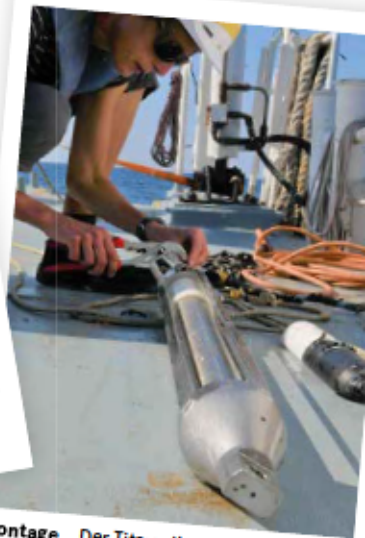
Montage Der Titanzylinder mit Empfängerlektronik wird in die Empfängerkette eingebaut.
