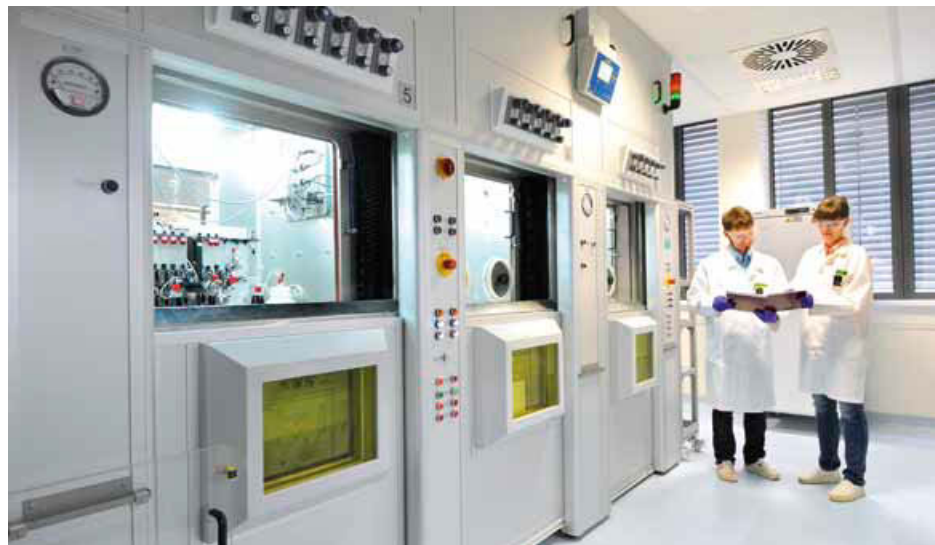
Gut abgeschirmt Der Umgang mit radioaktiven Stoffen erfolgt wie hier am Helmholtz-Zentrum Dresden-Rossendorf in sogenannten Heißen Zellen, die mit Bleiwänden ausgestattet sind. Bild: Frank Bierstedt/HZDR
